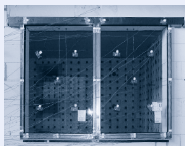
Messsonden-Anordnung an einer 2-teiligen EI30-Anlage. Disposition de sondes de mesure sur une installation EI30 à 2 éléments.
