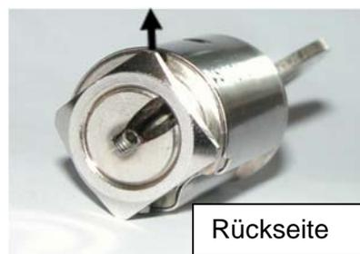
4. Zylinder in den vorderen Schlitten einführen.
