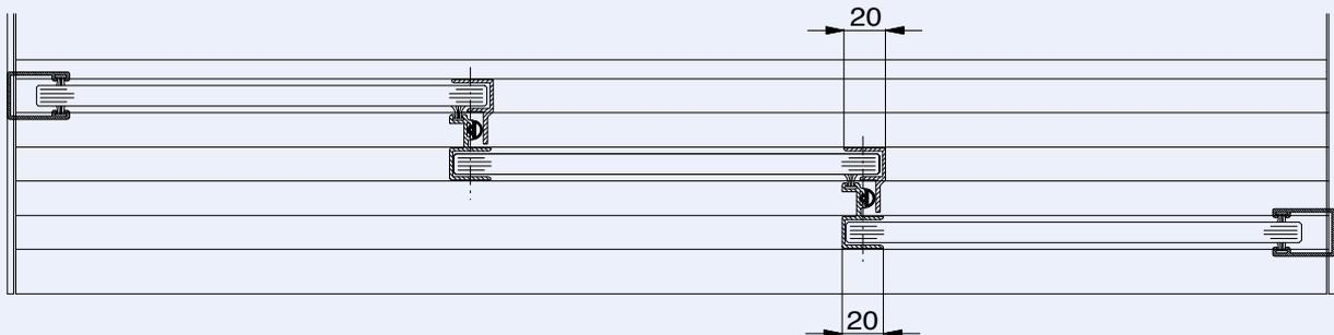
Ausführung mit Staubabdichtungen 90°, Mitnehmern und Druckzylinder-Verschluss
